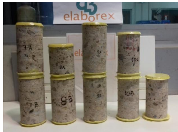
Fig. 5: Probetas testigos de hormigón
