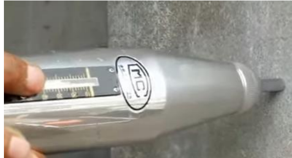
Fig. 1: Índice de rebote. Esclerómetro Schmidt
